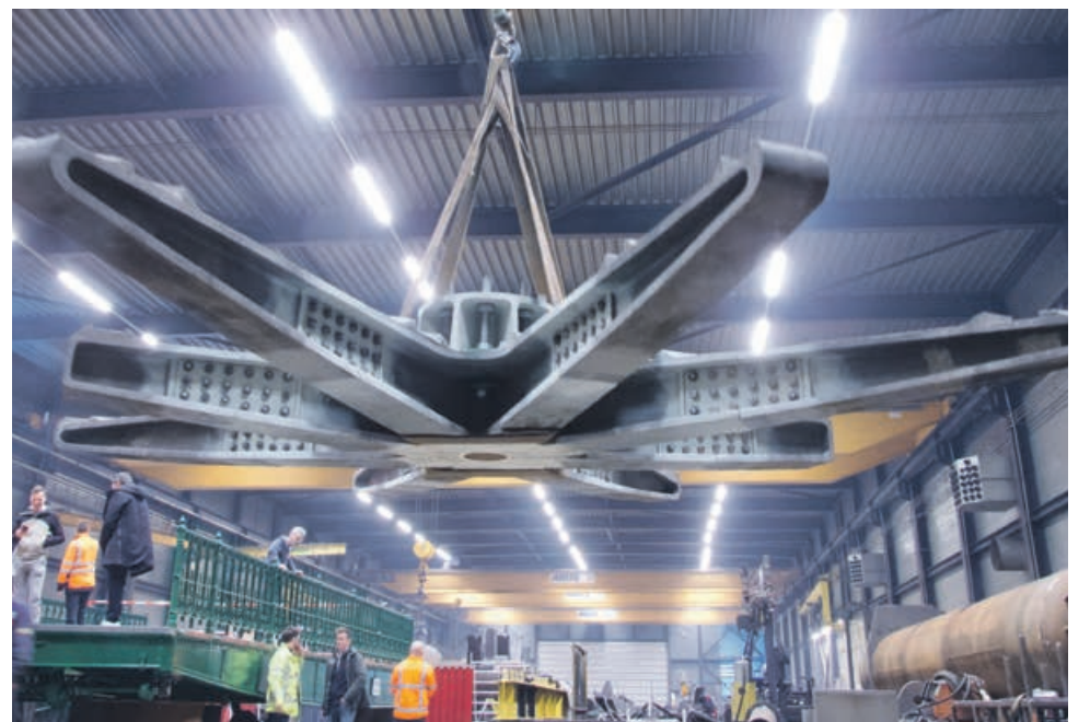
DE SPIN, HET DRAAIBARE DEEL VAN DE BRUG. HIER NOG ONGEVERFD IN DE FABRIEKSHAL VAN VAN DER ZALM IN BRAKEL
